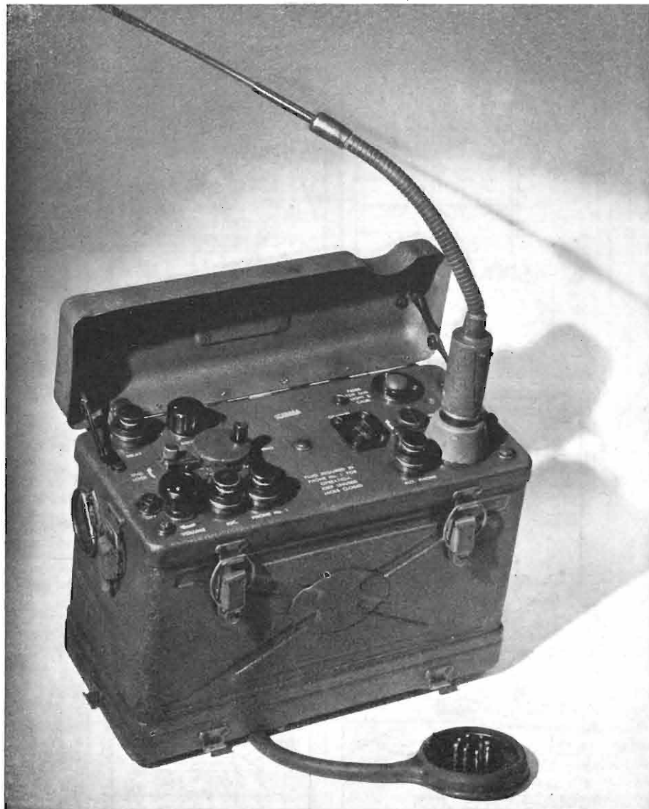
Fig. 3. - Aspetto di un ricetrasmittitore portatile a FM: il BC-1000 - A
