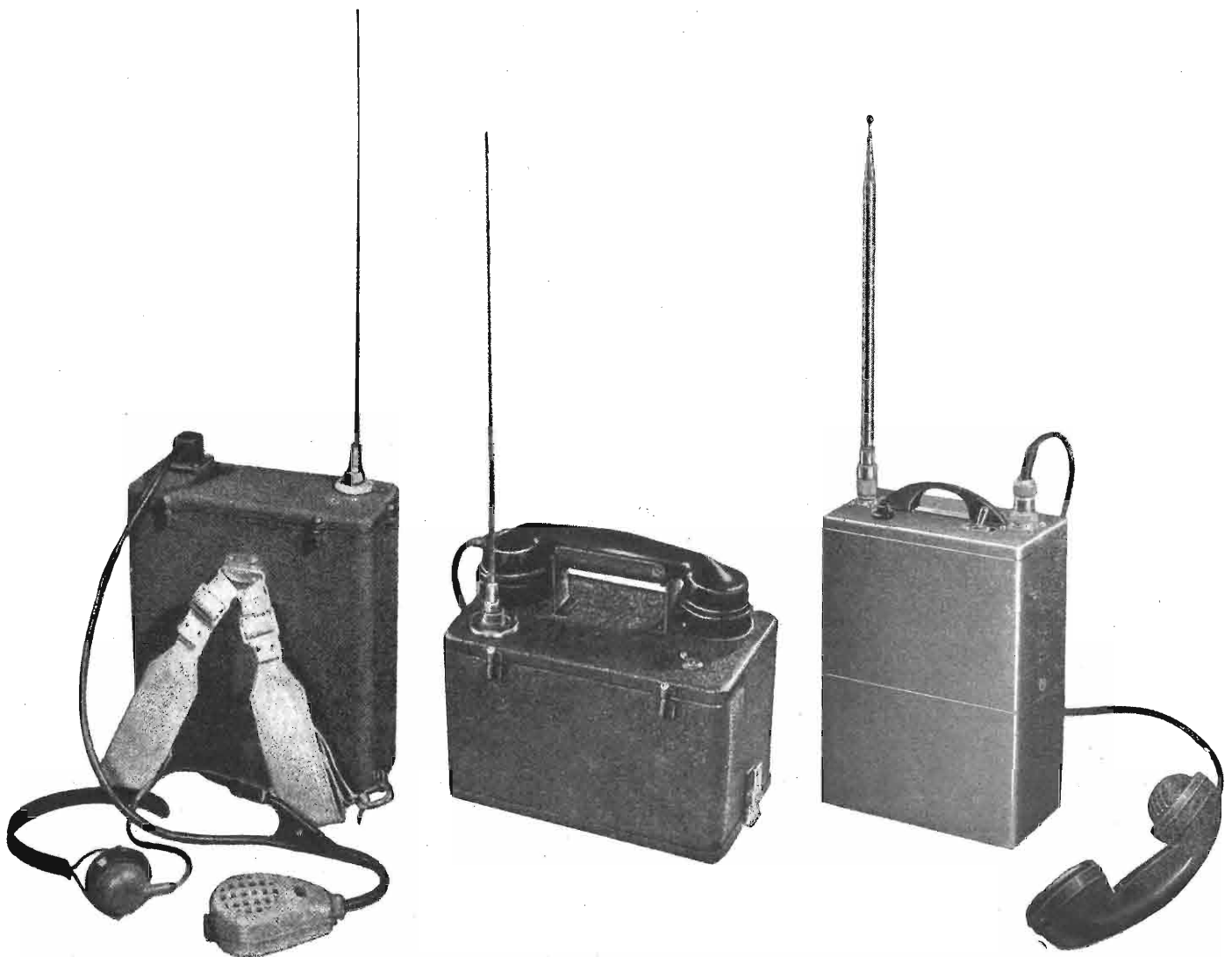
Fig. 10. - Tre modelli di ricetrasmittitori portatili; da sinistra il B.C.C. modello L45, il B.C.C. modello L59, il Tele - Kit VII.
