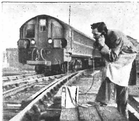
Fig. 4. - Esempio tipico di impiego di un radiotelefono nelle ferrovie.
